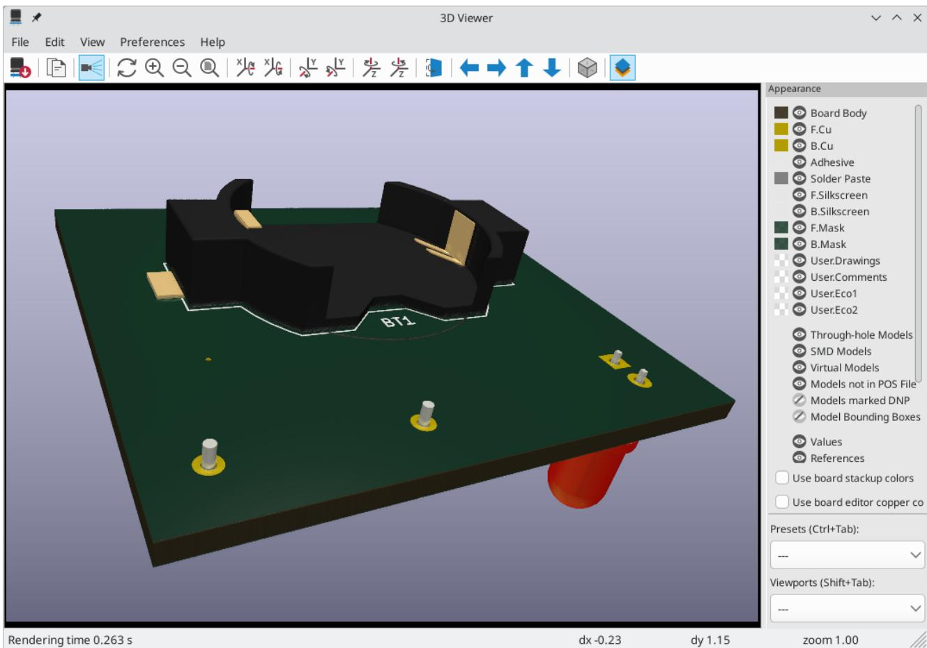
KiCad 库中的许多封装都带有 3D 模型，包括本指南中使用的所有封装。有些封装没有附带 3D 模型，《封装和 3D 模型》，但用户可以添加自己的模型》。
