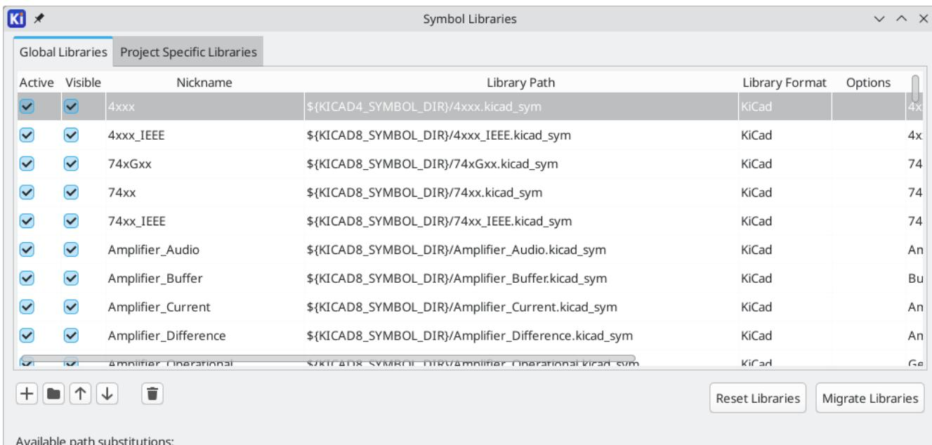
通常情况下，库的路径是通过路径替换变量定义的。这样，用户就可以在不修改库表的情况下，将所有库移动到新的位置。唯一需要更改的是重新定义变量，使其指向新位置。KiCad 的路径替换变量可通过项目管理器或任何编辑器窗口中的 **偏好设置 → 配置路径...** 进行编辑。
