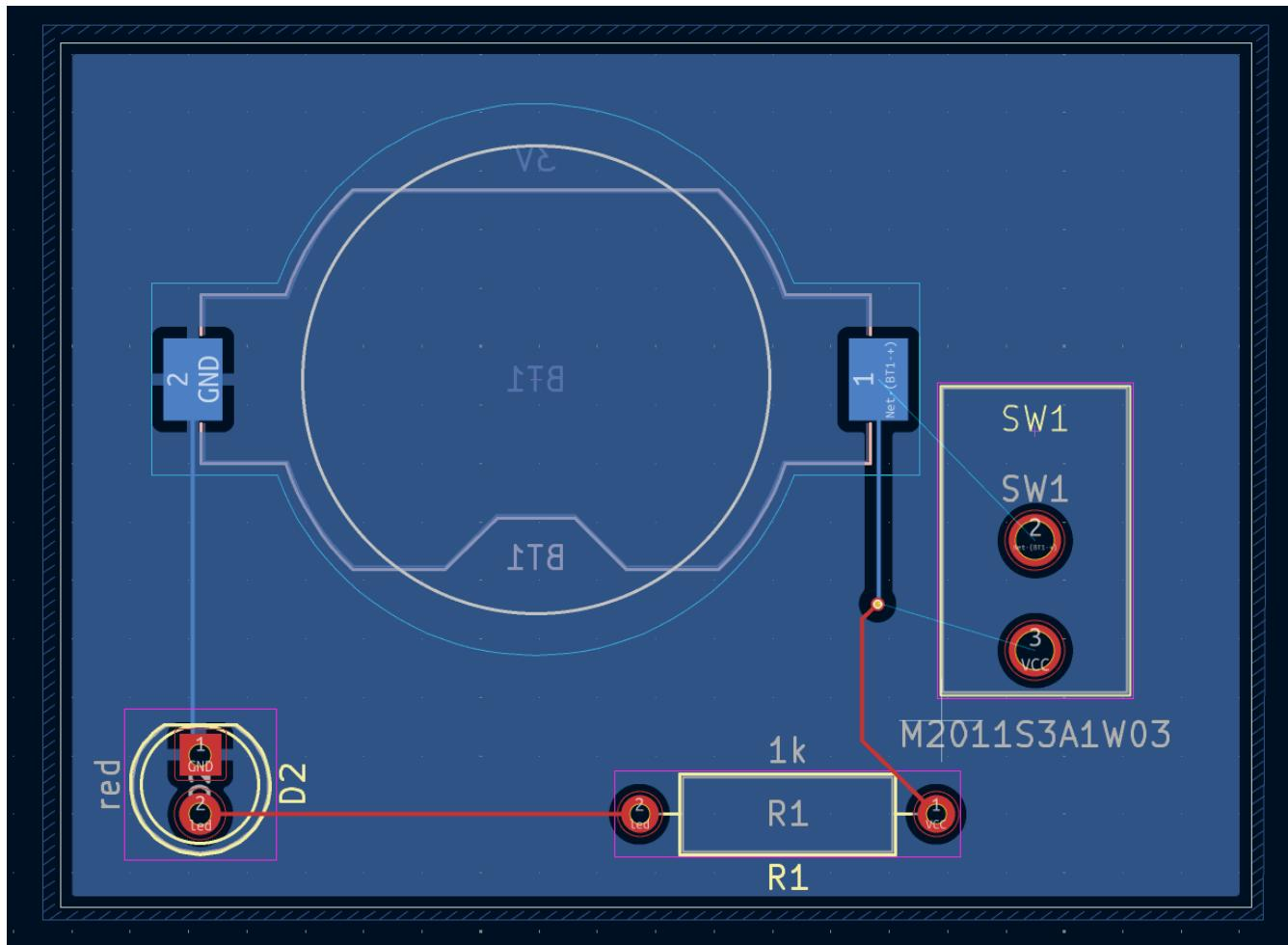
飞线显示了需要布线的新连接。此外，电池和电阻之间的连接也需要删除。
