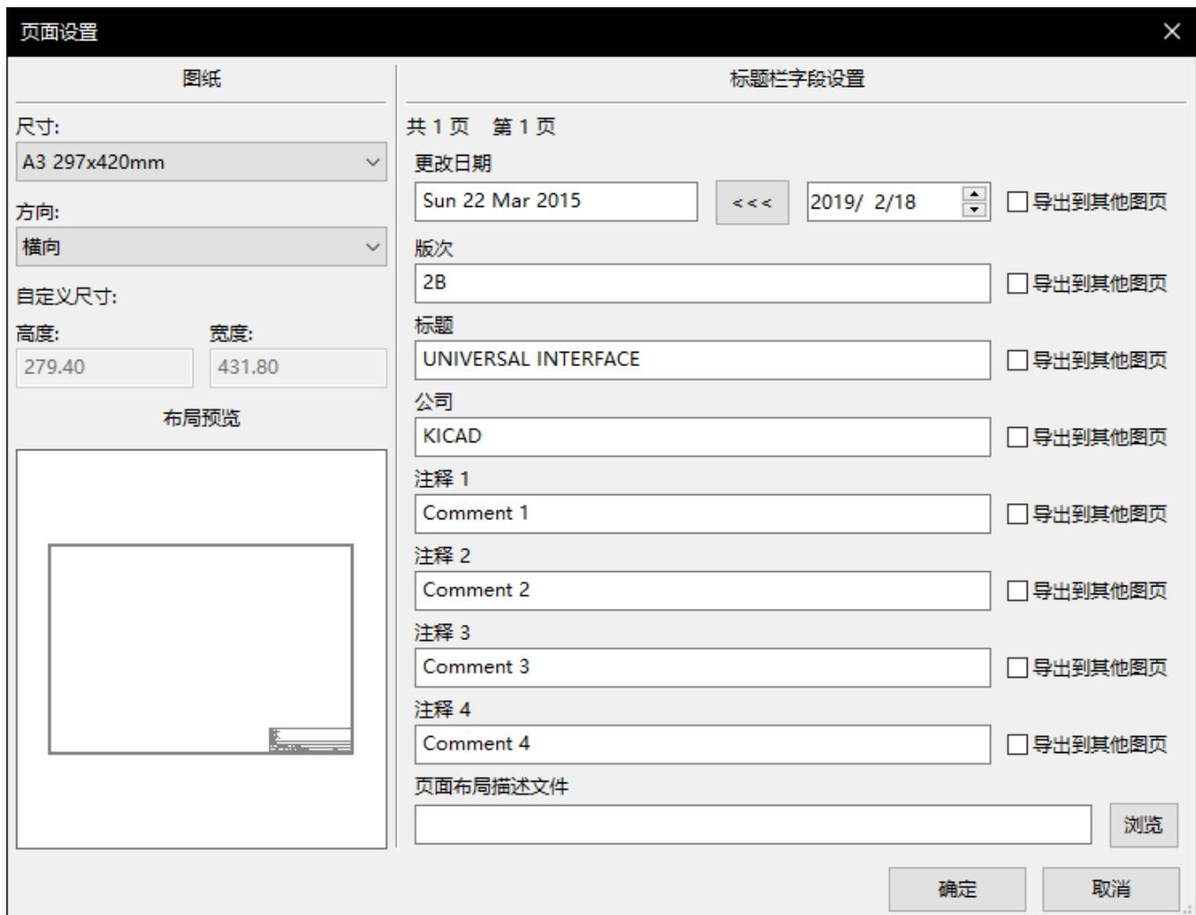
可以编辑标题栏中的每个字段，以及纸张大小和方向。如果为某个字段选中了 **导出到其他原理图页** 选项，则该字段将在所有原理图页的标题栏中更新，而不仅仅是当前原理图页。
