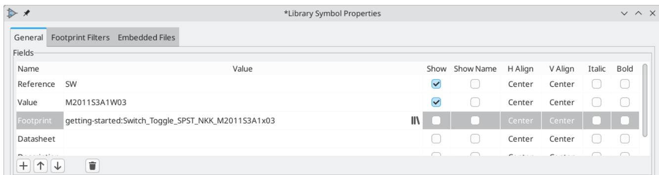
符号可以指定一个预选的封装。封装不需要手动分配给这些符号，因为在创建符号的时候就已经选择了一个封装。用户可以在封装分配过程中正常覆盖预选的封装。定义一个默认的封装对于那些通常或总是被分配相同封装的符号来说是个好主意，例如一个只在一个包中可用的元件。开关封装《默认封装，被设置为其匹配符号的默认封装》
