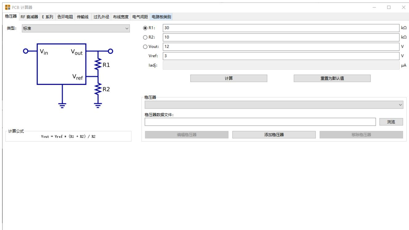
对于 标准型，输出电压  $V_{out}$  作为参考电压  $V_{ref}$  和电阻  $R_1$  和  $R_2$  的函数，由以下公式给出：
