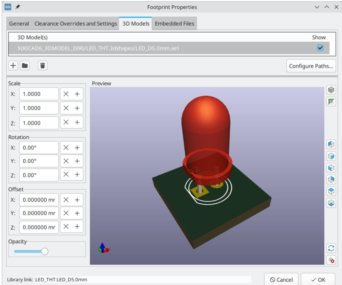
支持 STEP ( .step ) 和 VRML ( .wrl ) 两种 3D 模型格式。STEP 文件在需要尺寸精度的情况下非常有用，而 VRML 文件可以用来制作更具视觉吸引力的渲染图。KiCad 库中的许多封装都有相关的 3D 模型；这些模型都以 VRML 和 STEP 格式提供。两种模型中只有一种需要在封装中列出（通常是给出 VRML 文件名）。在为机械 CAD 目的导出电路板的 3D 模型时，KiCad 可以自动替换 STEP 版本。
