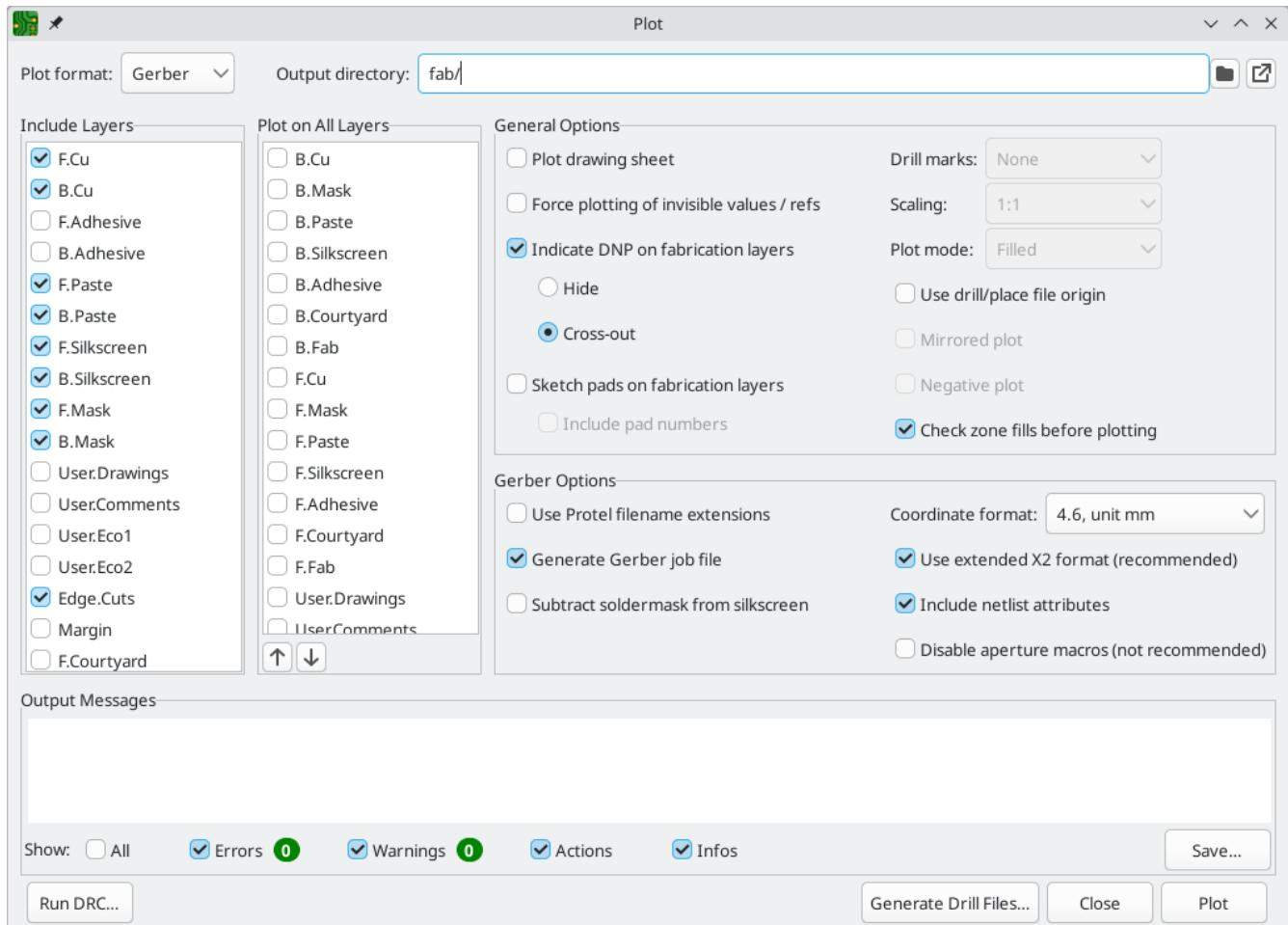
点击**绘制**来生成 Gerber 文件。同时点击**生成钻孔文件...**，然后点击**生成钻孔文件**来创建文件，指定所有将在电路板上钻孔的位置。最后，关闭“绘制”对话框。设计就完成了。
