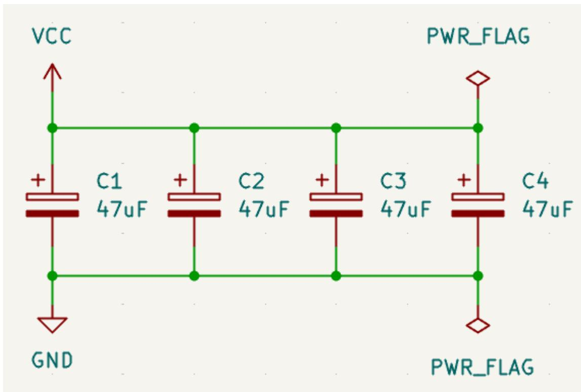
在 KiCad 标准库中，电源符号可以在 `power` 库中找到，但电源符号可以在任何库中创建。要创建一个自定义的电源符号，请创建一个新的符号，其电源输入引脚被设置为不可见。根据所需的电源网来命名该引脚。此外，设置“定义为电源符号”的符号属性。正如《隐藏的电源引脚,隐藏的电源引脚部分》所述，不可见的电源输入引脚根据隐藏的电源引脚的名称进行全局连接。创建电源符号的过程将在《创建电源符号,符号编辑器部分》中详细描述。
