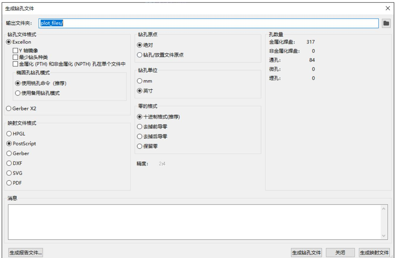
**输出文件夹：** 选择要保存生成的钻孔和映射文件的文件夹。如果输入相对路径，则它将相对于工程目录。
