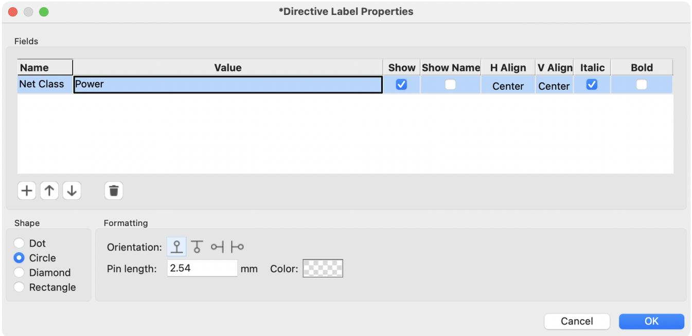
除了相关的网络类, 你还可以在指令的属性中编辑指令的**形状** (点、圆、钻石或矩形)、**方向**、**引脚长度** 和 **颜色**。
