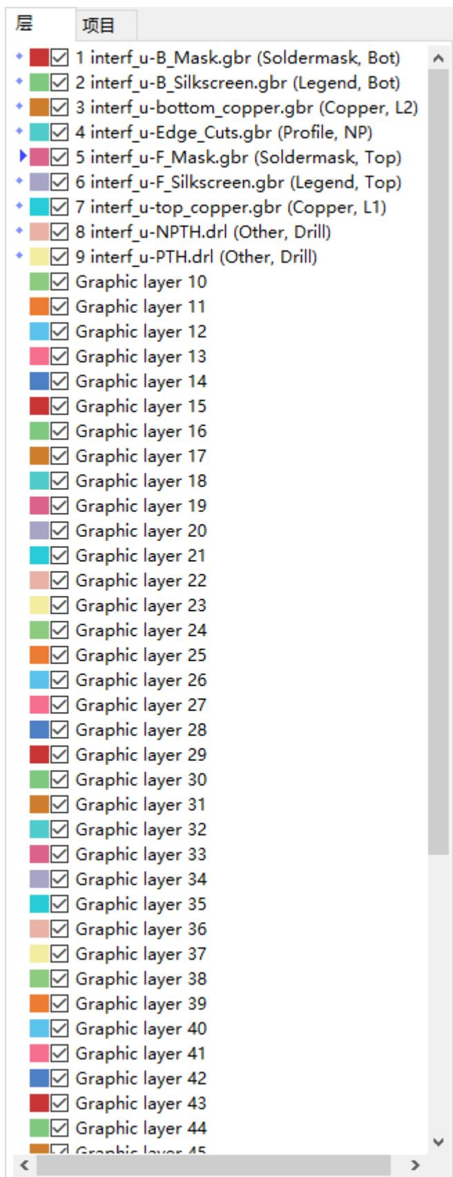
层管理器管理着所有图层的显示。左方的三角形箭头指示着当前的活动层，而每一层都可以使用复选框来开启或关闭显示。
