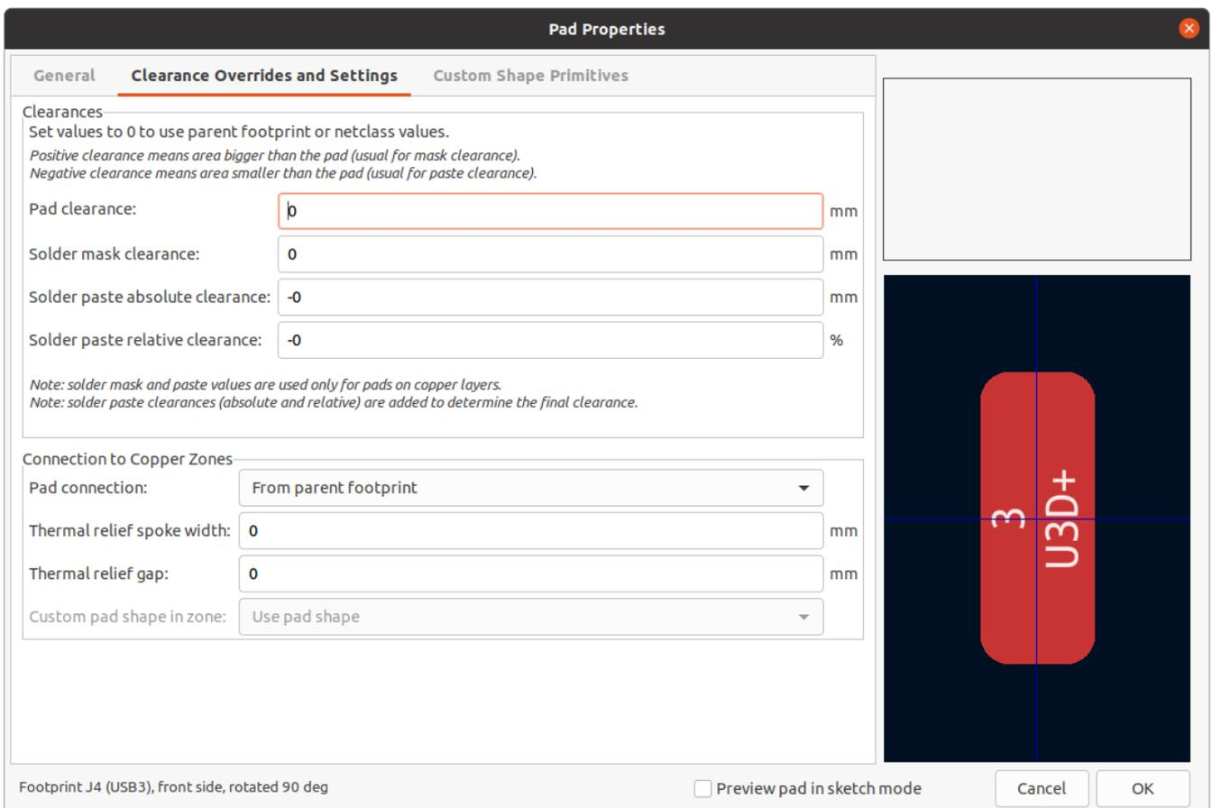
出现在任何技术层上的孔径将具有与铜层上的焊盘形状相同的形状和尺寸。在 PCB 制造过程中, 制造商经常会改变掩膜和浆料孔径相对于铜焊盘尺寸的相对尺寸, 但由于这种尺寸变化是特定于制造过程的, 大多数制造商希望在提供
