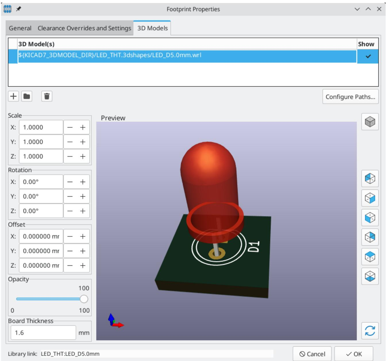
支持 STEP ( `.step` ) 和 VRML ( `.vrl` ) 两种 3D 模型格式。STEP 文件在需要尺寸精度的情况下非常有用，而 VRML 文件可以用来制作更具视觉吸引力的渲染图。KiCad 库中的许多封装都有相关的 3D 模型；这些模型都以 VRML 和 STEP 格式提供。两种模型中只有一种需要在封装中列出（通常是给出 VRML 文件名）。在为机械 CAD 目的导出电路板的 3D 模型时，KiCad 可以自动替换 STEP 版本。
