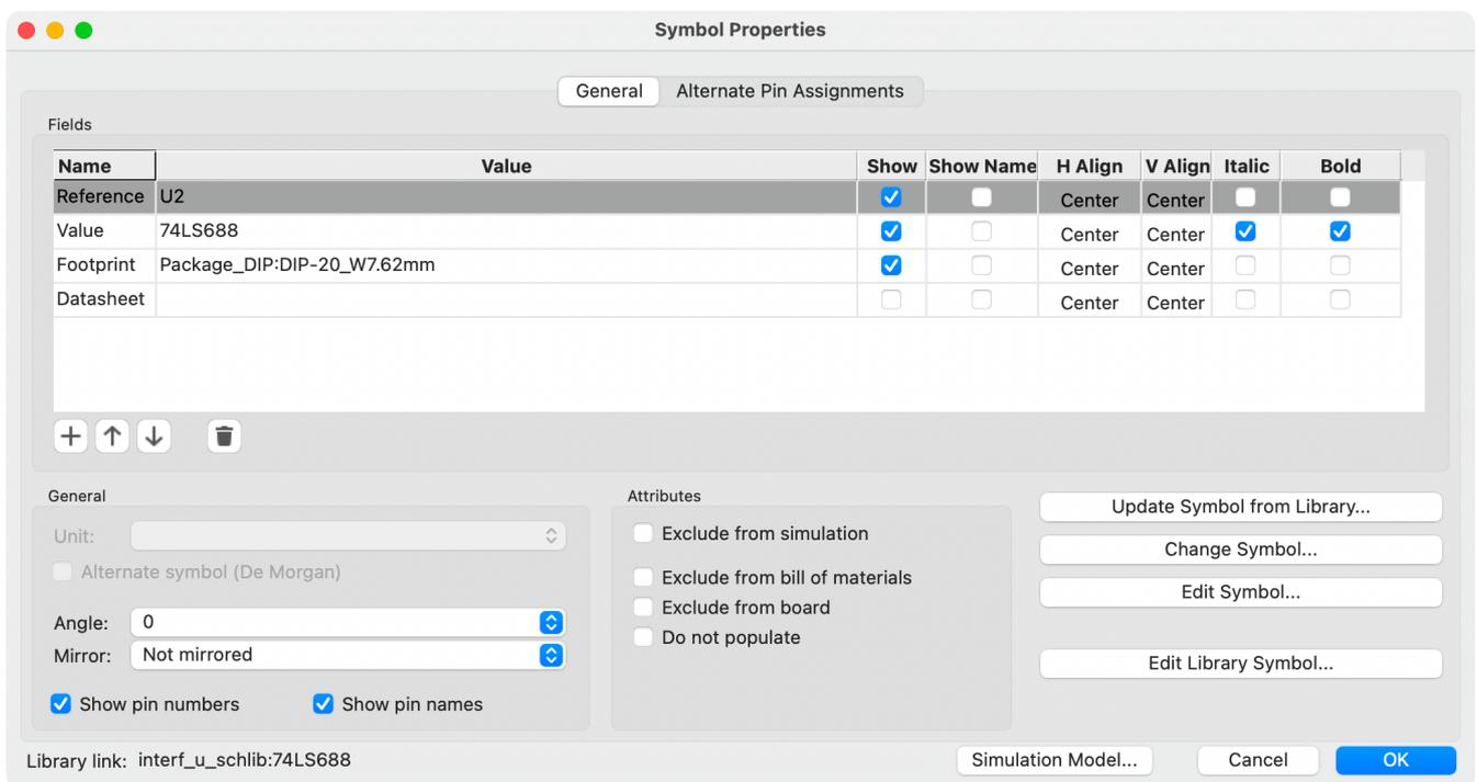
符号属性窗口在一个表格中显示一个符号的所有字段。新的字段可以被添加，现有的字段可以被删除、编辑、重新排序、移动或调整大小。
