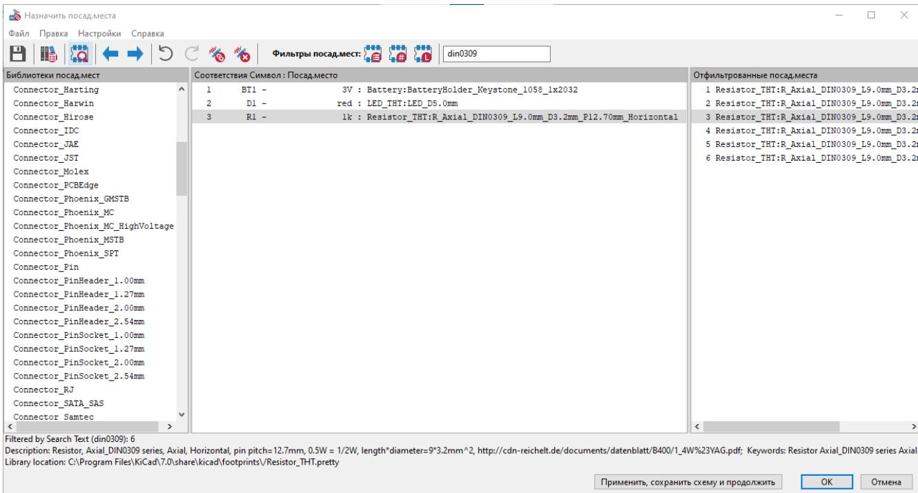
В состав KiCad входит множество посадочных мест, поэтому инструмент назначения посадочных мест предлагает несколько способов их фильтрации, позволяя скрыть те, которые не соответствуют рассматриваемому символу.
