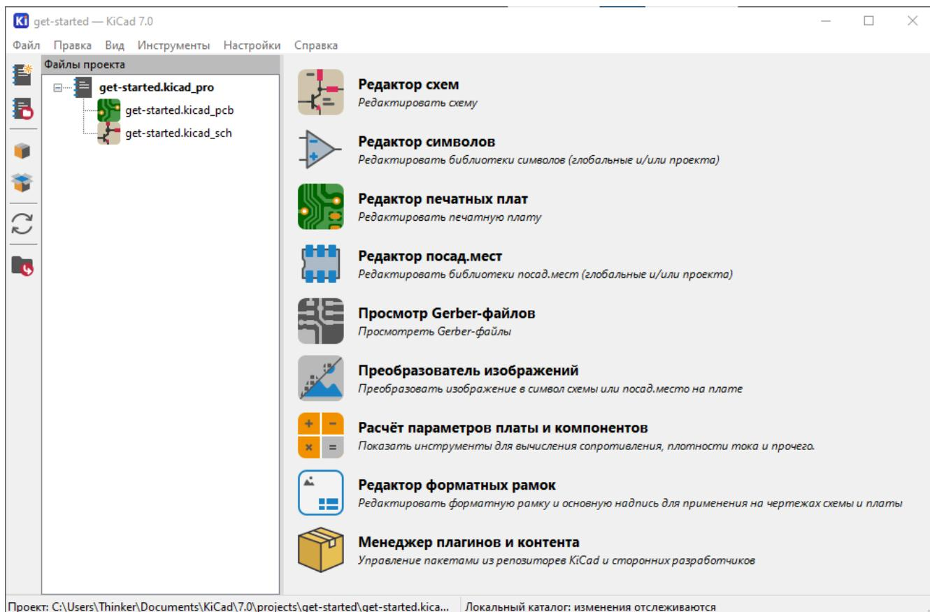
Слева, на панели "Файлы проекта", отображается список файлов текущего проекта: файл с расширением `.kicad_pro`, это файл проекта, файл с расширением `.kicad_sch` это схема, а файл с расширением `.kicad_pcb`, это печатная плата. Все они имеют общее название, состоящее из имени вашего проекта.
