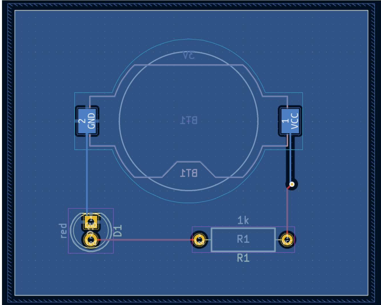
В KiCad зоны не заполняются автоматически при их создании, редактировании или при перемещении в них посадочных мест. Заполнение зон всегда производится вручную, а также при выполнении проверки правил проектирования (DRC) (примечание: если установлен соответствующий флажок). Убедитесь что заполнение зон актуально, прежде чем создавать выходные данные для производства.
