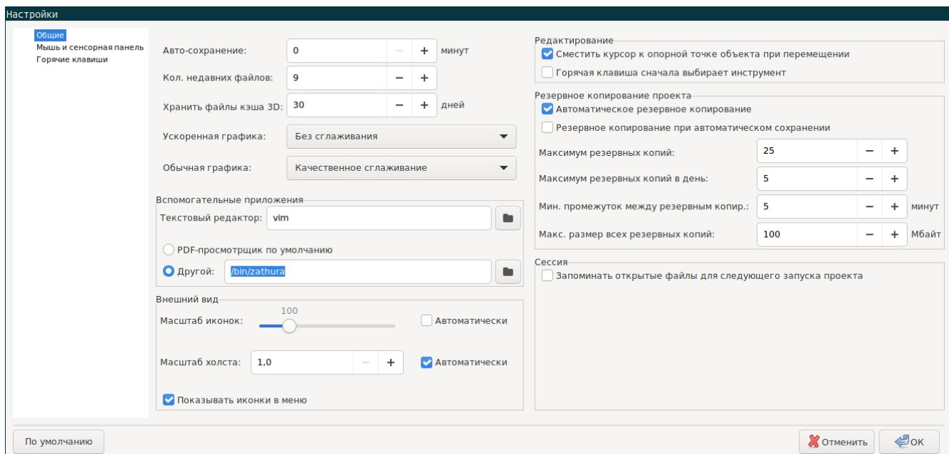
**Ускоренная графика:** KiCad может использовать различные методы сглаживания при отрисовке средствами графического адаптера. Эти методы могут выглядеть по-разному на разном оборудовании, поэтому следует поэкспериментировать для поиска наилучшего отображения.
