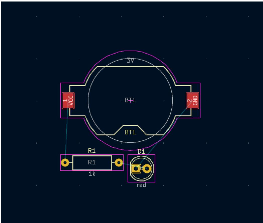
В KiCad обновление печатной платы с учётом изменений в схеме выполняется вручную: разработчик сам решает, когда целесообразно обновить плату, синхронизировав с изменениями в схеме. Каждый раз, когда редактируется схема, разработчик должен использовать инструмент **Обновить плату из схемы**, чтобы синхронизировать изменения.
