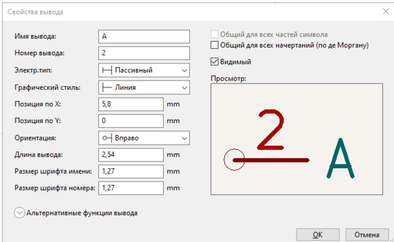
Добавьте второй вывод, но на этот раз не используя инструмент **Добавить вывод**, а просто нажав клавишу **Insert**. К символу добавится новый вывод под номером 3, расположенный непосредственно под выводом 2.
