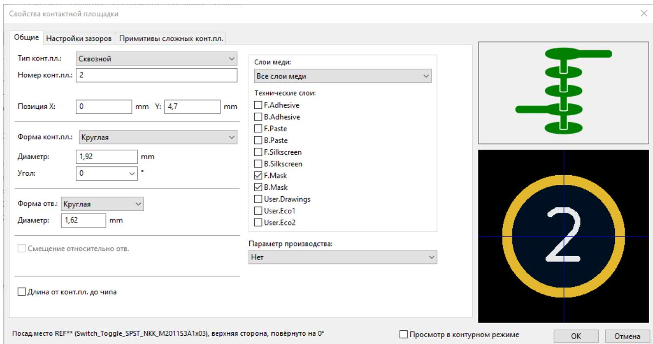
Далее, используя кнопку **Добавить контактную площадку**, разместите другой контакт в следующей точке (0, 9.4 мм). Обратите внимание на то, что номер контактной площадки автоматически увеличивается, а ее свойства, включая размер площадки и диаметр отверстия, копируются с предыдущей контактной площадки.
