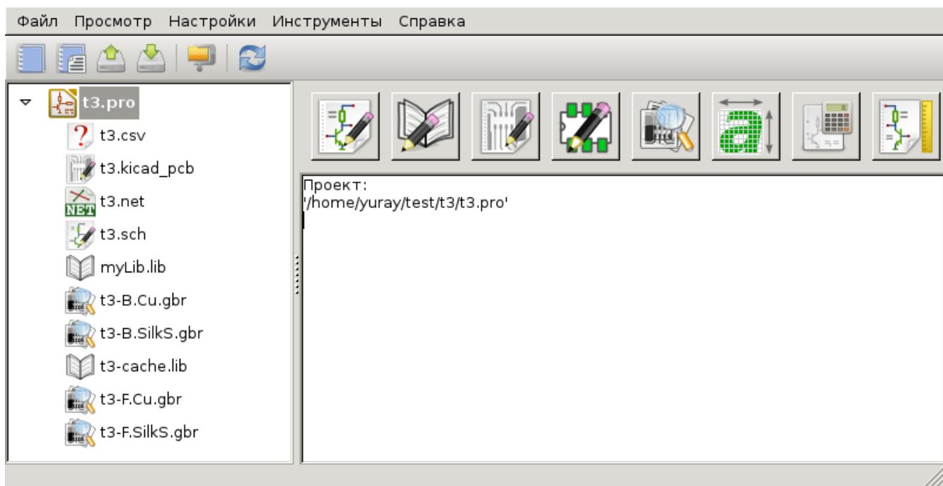
Окно менеджера проектов KiCad состоит из дерева проекта слева, отображающего файлы связанные с открытым проектом, и панели запуска приложений справа, содержащей кнопки различных редакторов и инструментов.
