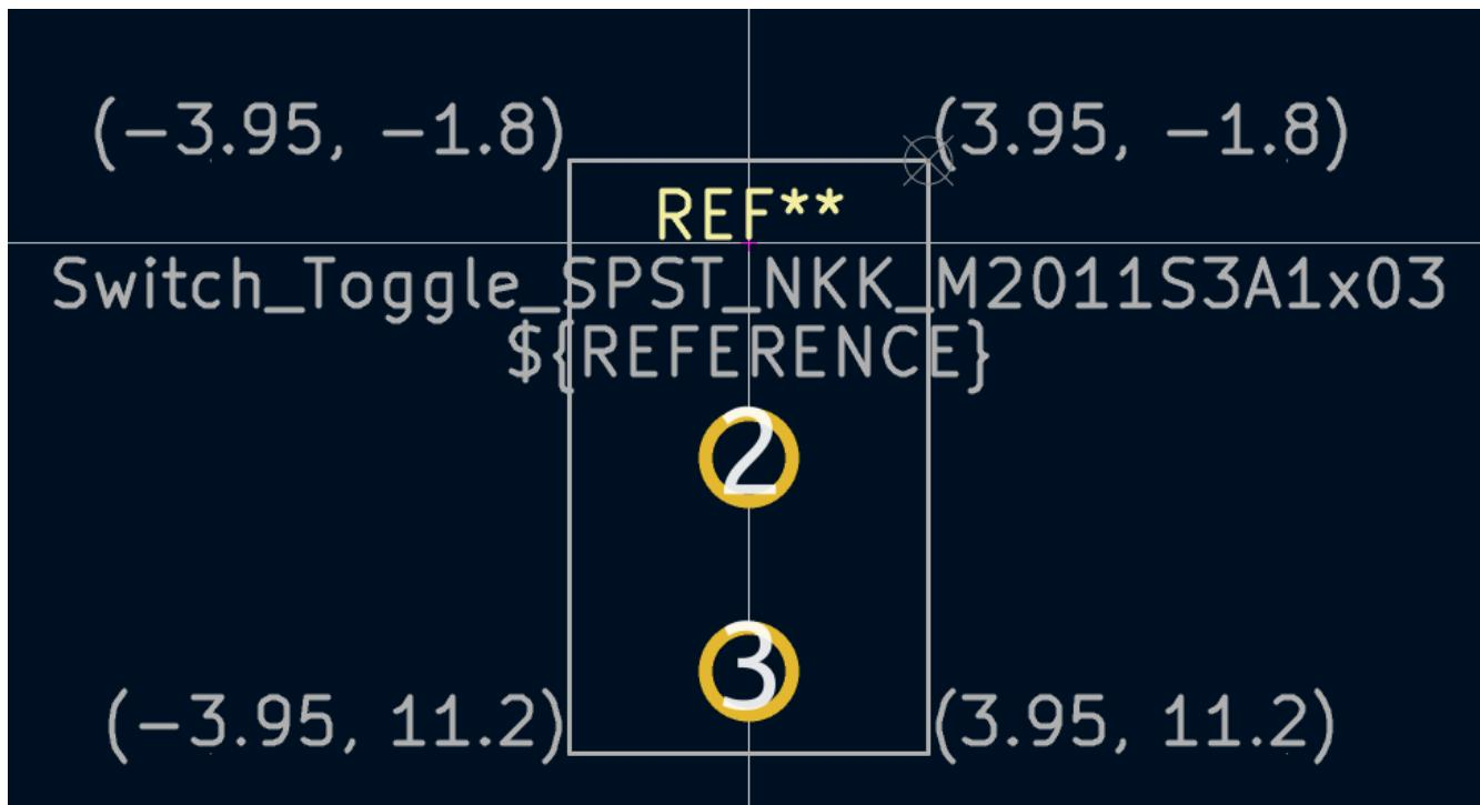
Затем переключитесь на слой `F.Silkscreen`. Контур шелкографии должен находиться непосредственно за контуром детали, поэтому линии шелкографии сдвинуты наружу от контура детали на 0.11 мм (половина (0.5 мм) ширины линии детали 0.10, плюс половина (0.6 мм) ширины линии шелкографии 0.12 мм). Точные координаты показаны на рисунке ниже, а удобные настройки сетки следующие:
